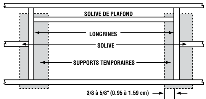
FIGURE 1 – OUVERTURE ENCADRÉE AVEC PLANCHETTES DE SUPPORT TEMPORAIRE PRÊTE À RECEVOIR L'ESCALIER
