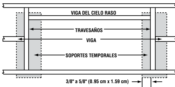
FIGURA 1 - ABERTURA CON TABLILLAS DE SOPORTE TEMPORAL LISTAS PARA RECIBIR LA ESCALERA
